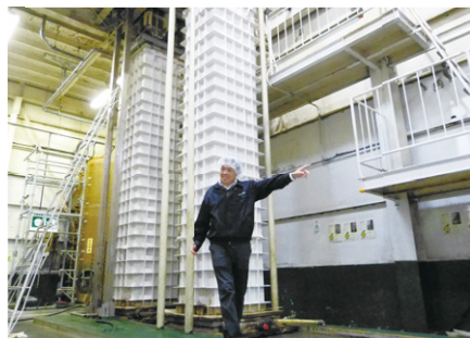
▲圧搾機 3日間かけてゆっくりと圧力をかける。初日は自然の重み、2日目は軽く、3日目は高圧力で搾る
